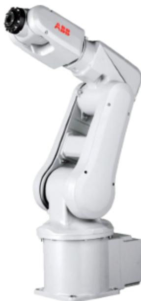
轴无外凸，回转半径极小，可靠近其他设备安装，纤细的手腕进一步增强了手臂的可达性。
